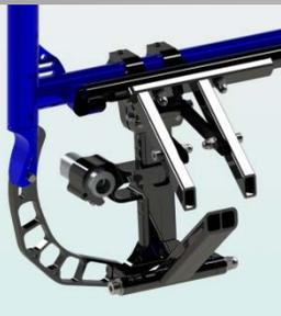
クロスフレームには従来の丸型パイプや角型パイプではなく、左右のねじれに強い特殊な断面形状のクロスフレーム用新型アルミ材を採用。
