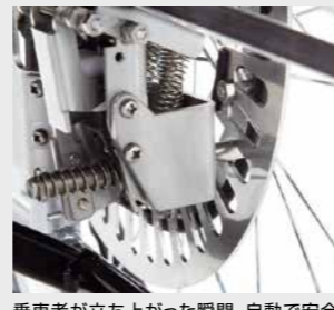
乗車者が立ち上がった瞬間、自動で安全ブレーキが安全を確保!
