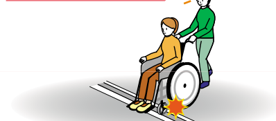
グレーチングや踏切へのキャスター挟み込み
