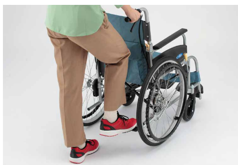
足踏みペダルもしくは片側のブレーキをかけるだけで、左右の駐車ブレーキが連動してかかります。
