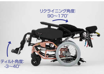
ティルト+リクライニング機能 新車注文時 31,000円(非課税) (1台分) リクライニング支点を座面から3・5・7cm上のいずれかより選択してください。 リクライニング機能は転倒防止装置(オプション)との併用をおすすめします。
